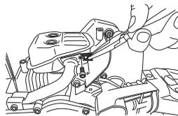
В некоторых глушителях предусмотрен специальный искрогаситель. Если ваш инструмент оборудован таким глушителем, искроулавливающую сетку следует периодически очищать. Для этой цели лучше всего использовать стальную щетку.
