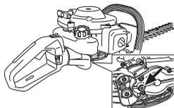
**ВНИМАНИЕ!** Обратите внимание на то, что передача не должна заполняться смазкой полностью. Солидол расширяется при нагревании в результате работы двигателя. Если коробка передач будет полностью заполнена солидолом, появится риск повреждения прокладок и утечки смазки.
