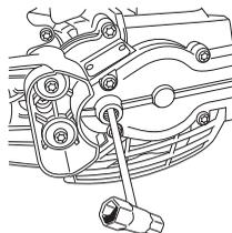
Смазка траверсов ножей производится специальной смазкой арт. номер 531 00 75-12 (УЛ 21) перед каждым использованием.
