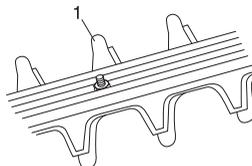
Проверьте щиток ножа, чтобы он не был поврежден и деформирован. Если режущий блок деформирован или поврежден, следует произвести его замену.
