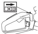
Запустите двигатель и проверьте, чтобы он остановился при переводе выключателя в положение стоп. Контакт остановки автоматически возвращается в положение запуска. Во избежание непроизвольного запуска, колпачок зажигания следует всегда снимать со свечи зажигания при монтаже, проверке и/или обслуживании.
