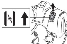
**Топливный насос:** Сожмите несколько раз резиновую грушу топливного насоса пока в нее
