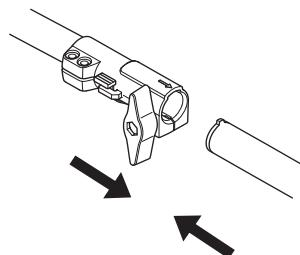
Перед использованием узла, хорошо затяните ручку.
