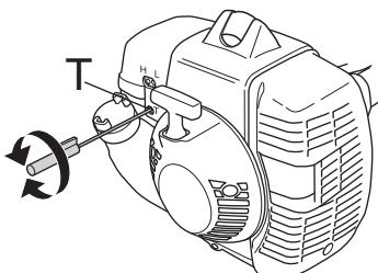
**ПРЕДУПРЕЖДЕНИЕ!** Если холостые обороты невозможна отрегулировать так, чтобы режущее оборудование стояло неподвижно, обращайтесь к продавцу/в мастерскую. Не пользуйтесь машиной, пока не будет выполнена точная регулировка или ремонт.
