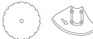
Лезвие и нож для травы предназначены для выкашивания сильной травы.
