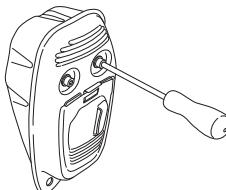
Если глушитель на вашей машине дополнительно оборудован искрогасящим фильтром, его следует регулярно прочищать. Забившийся фильтр может вызвать перегрев двигателя и привести к серьезным повреждениям двигателя.
