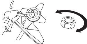
Нейлоновая прокладка контргайки не должна быть изношена настолько, чтобы ее можно было поворачивать вручную. Прокладка должна выдерживать усилие минимально 1,5 Нм. Гайку следует заменить после ее использования приблизительно 10 раз.
