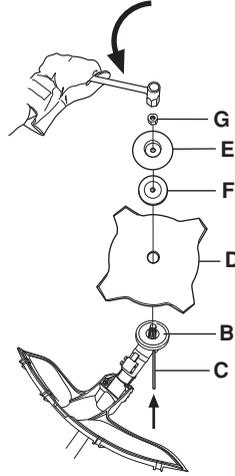
Установка щитка и триммерной головки
