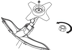
При сборке надо затягивать гайку против направления вращения режущего оборудования. При разборке надо отвинчивать гайку в направлении вращения режущего оборудования. (ЗАМЕЧАНИЕ! Гайка имеет левостороннюю
