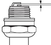
**ВНИМАНИЕ!** Всегда используйте только указанный тип свечи! Применение несоответствующей модели может привести к серьезным повреждениям поршня/цилиндра. Следите за тем, чтобы свеча была оснащена т.н. изоляцией радиопомех.
