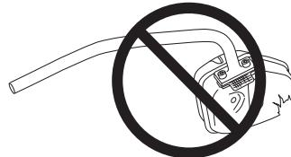
Периодически проверяйте, чтобы глушитель был надежно закреплен на корпусе машины.
