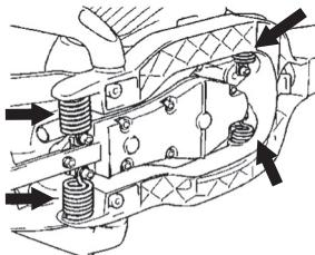
Корпус двигателя и режущий блок подвешены к ручкам на четырех пружинах.
