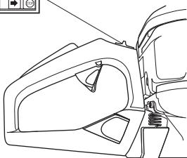
Запустите двигатель и проверьте, чтобы он остановился при переводе выключателя в положение стоп.
