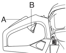
Проверьте, чтобы ручка газа в момент возвращения блокировочного рычага в исходное положение была блокирована на холостом ходу.
