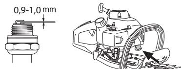
**ВНИМАНИЕ!** Всегда используйте только указанный тип свечи! Применение несоответствующей модели может привести к серьезным повреждениям поршня/цилиндра. Следите за тем, чтобы свеча была оснащена т.н. изоляцией радиопомех.
