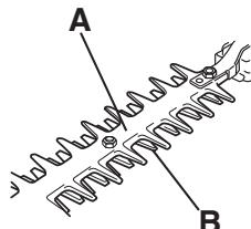
Проверьте щиток ножа, чтобы он не был поврежден и деформирован. Замените щиток ножа, если он согнут или поврежден.
