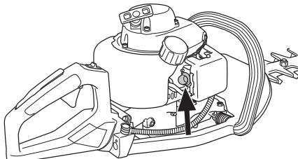
**Заслонка топлива:** Установите заслонку топлива в положение сътнения.
