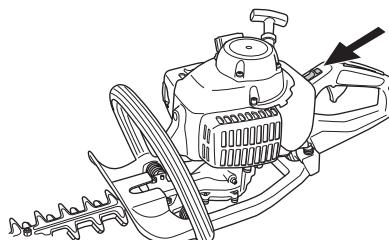
В случае если двигатель не останавливается после переведения выключателя в положение остановки, установите заслонку в закрытое положение (заслонка закрыта). Обращайтесь в ваш сервисный центр.
