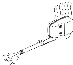
Если глушитель на вашей машине дополнительно оборудован искрогасящим фильтром, его следует регулярно прочищать. Забившийся фильтр может вызвать перегрев двигателя и привести к серьезным повреждениям двигателя.
