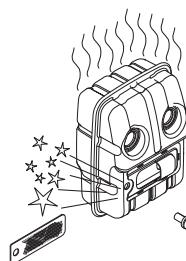
Если на вашем инструменте стоит глушитель такого типа, то сетку следует очищать не реже одного раза в неделю. На глушителях с катализатором, такую очистку достаточно производить раз в месяц. При возникновении повреждений на сетке ее следует заменить. Если сетка часто бывает засорена, значит функция катализатора ухудшена. Обращайтесь к вашему продавцу за советом. Засорение сетки вызовет перегрев двигателя и повреждение цилиндра и поршня.
