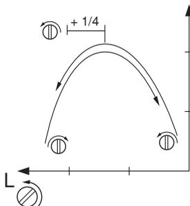
**ВНИМАНИЕ!** Если цепь вращается в течении холостого хода вам надо повернуть винт T против часовой стрелки до ее полной остановки.
