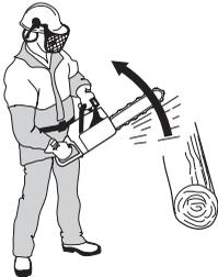
Проверьте, чтобы вы стабильно шли и стояли. Во время работы стойте с левой стороны дерева. Для максимального контроля пилу следует держать как можно ближе. По возможности весь вес пилы следует направить на ствол.
