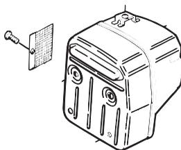
В некоторых глушителях предусмотрен специальный искрогаситель. Если ваша машина оборудована таким глушителем, сетку фильтра следует чистить раз в неделю. Наилучшие пользователи стальной щеткой. Забитая решетка приводит к работе с горячим двигателем, что дает серьезные повреждения двигателя.
