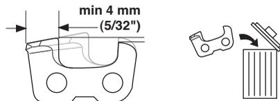
Общие сведения относительно снижения ограничителя глубины врезания.
