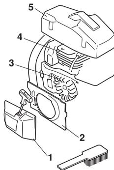
Производите очистку системы охлаждения щеткой раз в неделю или чаще, если этого требуют условия работы. Загрязненная или засоренная система охлаждения может привести к перегреву машины и вызвать повреждение поршня и цилиндра.
