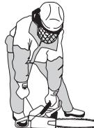
После того, как двигатель сделает первую вспышку, верните сразу рычаг воздушной заслонки в первоначальное положение, открывая воздушную заслонку, и повторите
