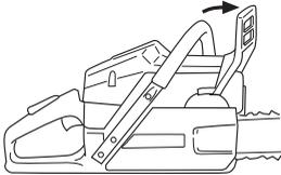
**Зажигание:** Установите переключатель зажигания в левое положение.
