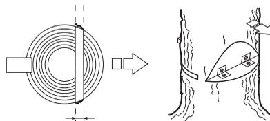
Возможность влияния на направление падения будет полностью утрачена, если полоса разлома слишком узкая или пропилована направляющий и основной пропилов плохо размещены.
