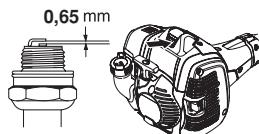
**ВНИМАНИЕ!** Всегда используйте только указанный тип свечи! Применение несоответствующей модели может привести к серьезным повреждениям поршня/цилиндра. Следите за тем, чтобы свеча была оснащена т.н. изоляцией радиопомех. См. Раздел Технические характеристики.
