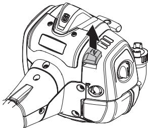
Достать воздушный фильтр, сняв крышку цилиндра. Промыть в чистой, теплой мыльной воде. Перед сборкой удостовериться, что фильтр сухой.
