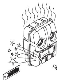
Сетку на глушителе катализатора необходимо раз в месяц проверять и при необходимости очищать. Используйте проволочную щетку. При наличии повреждений на сетке ее необходимо заменить. Если сетка часто бывает засорена, значит функция катализатора ухудшена. Обращайтесь к вашему продавцу за советом. Засорение сетки вызовет перегрев двигателя и повреждение цилиндра и поршня.
