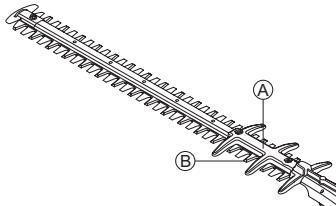
Проверьте щиток ножа, чтобы он не был поврежден и деформирован. Погнутые или поврежденные щитки лезвий необходимо заменять.
