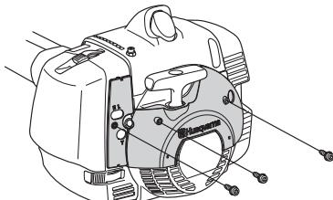
Демонтируйте воздушный фильтр машины и крышку воздушного фильтра. Смонтируйте воздушный фильтр и крышку воздушного фильтра из зимнего набора.
