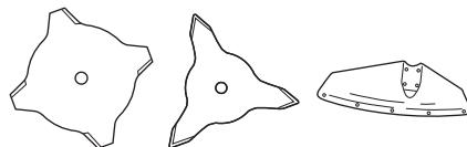
Лезвия для рубки предназначены для выкашивания сильной травы и срезания кустов.
