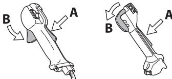
Проверьте, чтобы ручка газа в момент возвращения блокировочного рычага в исходное положение была блокирована на холостом ходу.
