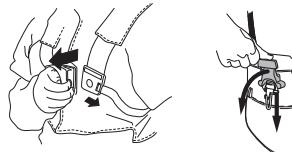
Удостоверьтесь, что привязные ремни оснастки были правильно расположены. Когда машина будет отрегулирована, проверьте работу системы быстрого отстегивания оснастки.
