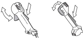
См. указания в разделе Запуск. Включите машину и полностью откроите дроссель. Отпустите рычаг дросселя и удостоверьтесь, что режущее оборудование останавливается и остается неподвижным. Если после постановки дросселя в положение холостого хода режущие оборудование продолжает вращаться, следует проверить регулировку холостого хода
