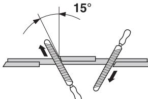
Отрегулируйте разводку. Она должен составлять 1 мм.
