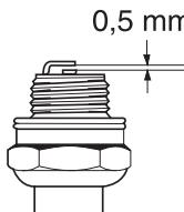
**ВНИМАНИЕ!** Всегда используйте только указанный тип свечи! Применение несоответствующей модели может привести к серьезным повреждениям поршня/цилиндра. Следите за тем, чтобы свеча была оснащена т.н. изоляцией радиопомех.
