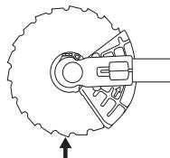
При ослаблении и затягивании гайки лезвия для пиления, рука может быть травмирована зубьями лезвия. Страйтесь, чтобы при этой работе ваша рука всегда была защищена щитком лезвия. Эта задача облегчается за счет
