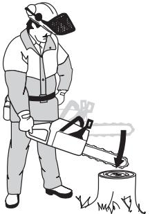
При прикосновении пильного полотна к пню должен сработать тормоз.
