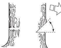
Линия, на которой сходятся два этих пропила, называется направляющей линией. Эта линия должна быть строго горизонтальной и составлять прямой угол (90 градусов) к предполагаемому направлению падения.
