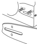
Для этого поверните винт механизма регулировки цепи по часовой стрелке. Цепь следует натягивать до тех пор, пока она не будет плотно прилегать к нижней стороне пильного полотна.
