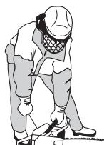
После того, как двигатель сделает первую вспышку, верните сразу рычаг воздушной заслонки в первоначальное положение,
