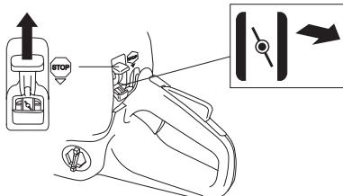
**Газ запуска:** Положение комбинации съединение/газ запуска получим когда установим ручку в положение съединения.
