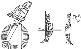
Закончить основной пропил нужно параллельно линии направляющего пропила так, чтобы расстояние между ними составляло около 1/10 диаметра ствола. Нераспиленный участок ствола называется полосой разлома (недопил).
