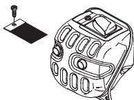
Глушитель служит для снижения уровня шума и отвода раскаленных выхлопных газов от рабочего. Выхлопные газы очень горячие и могут содержать искры, что может привести к пожару при прямом попадании на сухой и воспламеняющийся материал.
