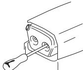
В некоторых глушителях предусмотрен специальный искрогаситель. Если ваша машина оборудована таким глушителем, сетку фильтра следует чистить раз в неделю. Наилучшие пользуйтесь стальной щеткой. Забитая решетка приводит к работе с горячим двигателем, что дает серьезные повреждения двигателя.
