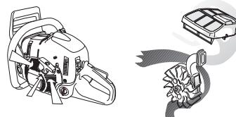
**ВАЖНО!** Для осуществления метода центробежной очистки нужно постоянно выполнять техническое обслуживание и уход за системой. Необходимо чистить воздухозаборник стартера, лопасти вентилятора на маховике, пространство вокруг маховика, входного коллектора и карбюратора.
