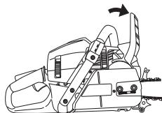
**Зажигание; подсос:** Установите рычаг подсоса в положение подсоса. Выключатель при этом должен автоматически перейти в положение пуска.
