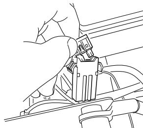
При замене не использовать плавкий предохранитель другого типа.
