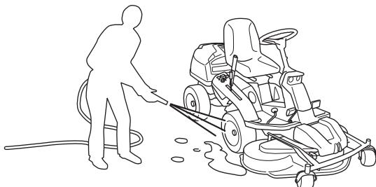
Масляные загрязнения могут быть сняты холодным обезжиривателем. Распылите тонкий слой.
