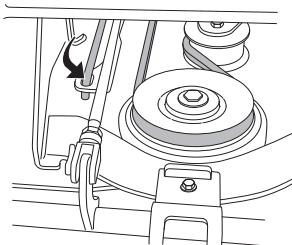
10 Закрепите прижимную пружину.
