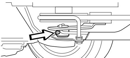
При ежедневном использовании, смазку следует производить два раза в неделю.
