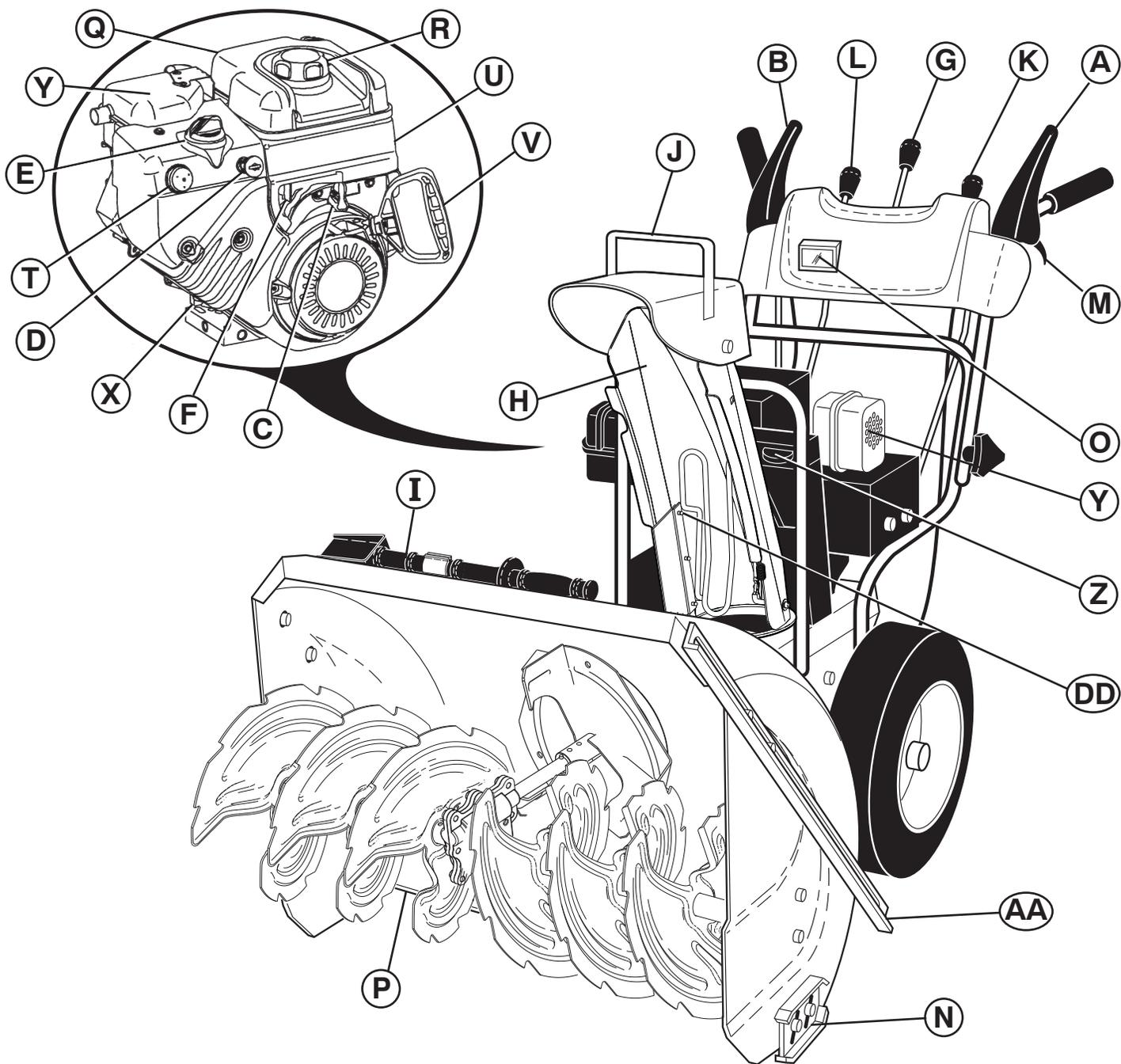
**A.** РЫЧАГ УПРАВЛЕНИЯ ПРИВОДОМ ТЯГИ
