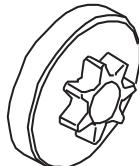
Следует регулярно проверять степень износа звездочки привода. Заменять при сильном износе. При замене цепи следует одновременно заменять и звездочку привода.
