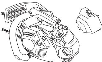
Для более тщательной чистки фильтр следует помыть в воде с мылом.
