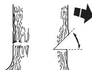
Линия, на которой сходятся два этих пропила, называется направляющей линией. Эта линия должна быть строго горизонтальной и составлять прямой угол (90 градусов) к предполагаемому направлению падения.
