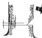
Вставьте зубчатый упор (если установлен) сзади надреза. Работайте на полном газу и вводите пильное полотно в ствол дерева постепенно. Следите за тем, чтобы верхушка дерева не начала перемещаться в направлении, противоположном предполагаемому направлению падения.
