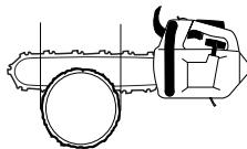
Существуют методы валки деревьев с полотном, меньшим диаметром ствола. Однако эти методы достаточно опасны, т.к. область отдачи полотна входит в контакт с предметом.
