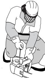
Как только заработает двигатель (это можно определить по характерному звуку), нажмите кнопку пускового устройства. С силой вытягивайте шнур, пока не запустится двигатель. Когда двигатель запустится, дайте
