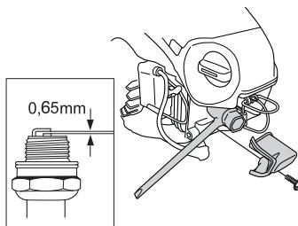
Обратите внимание! Всегда используйте только указанный тип свечи! Применение несоответствующей модели может привести к серьезным повреждениям поршня/цилиндра. Следите за тем, чтобы свеча была оснащена т.н. изоляцией радиопомех.
