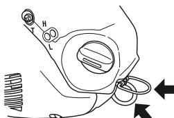
б) Используйте соответствующие карабины для непрямого (например, с помощью стропа) и прямого (например, непосредственно в точке крепления) присоединения пилы к обвязке оператора.
