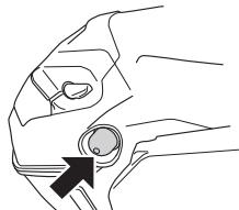
**Зажигание:** Перевести выключатель зажигания в положение включения.
