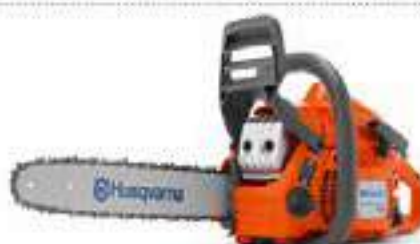
HUSQVARNA 135 e-SERIES 40,9 см³, 1,5 кВт, длина шины 36–40 см, 4,6 кг. Air Injection™, X-Torq и Low Vib. Не поставляется в Россию.
