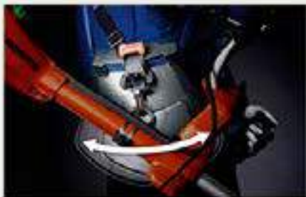
Смягчающая удары „плавающая“ подвеска для крепления инструмента.
