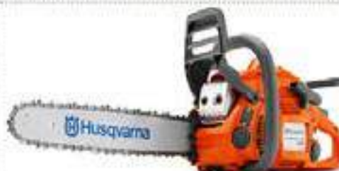
HUSQVARNA 440 e-SERIES TRIOBRAKE™ 40,9 см³, 1,8 кВт, длина шины 33–45 см, 4,4 кг. Air Injection™, X-Torq и Low Vib. В Россию поставляется модификация без TrioBrake™.
